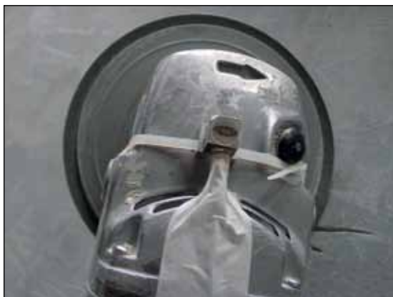
Figura 5 Ilustração de montagem em situações nas quais o operador não utiliza o punho auxiliar da ferramenta
