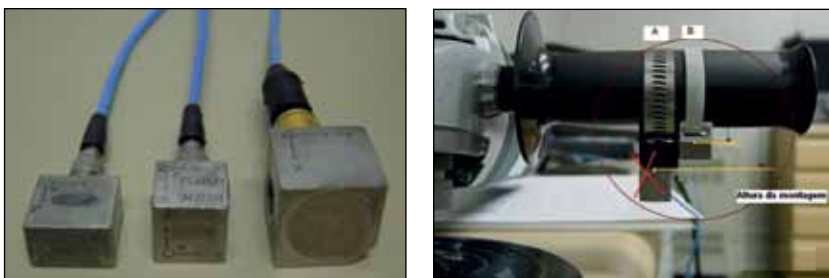
Figura 4 (a) Exemplo de montagens de acelerômetros triaxiais; (b) Exemplo de tipos de acelerômetros triaxiais
