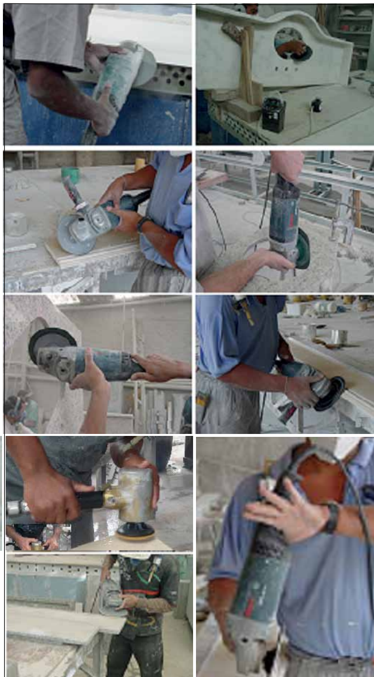
Figura 3 Ilustração de diferentes posturas e empunhaduras dos operadores durante rotinas de trabalho operando ferramentas manuais
