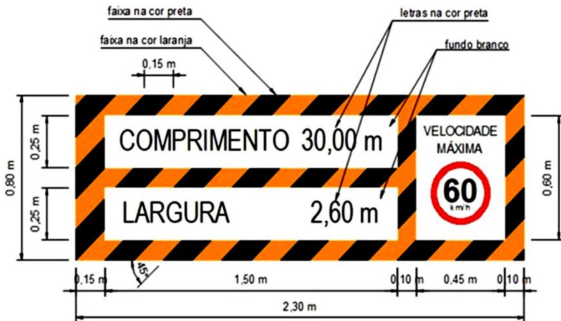
Figura 7: Sinalização especial de advertência traseira para comprimento e largura excedente e limite de velocidade
