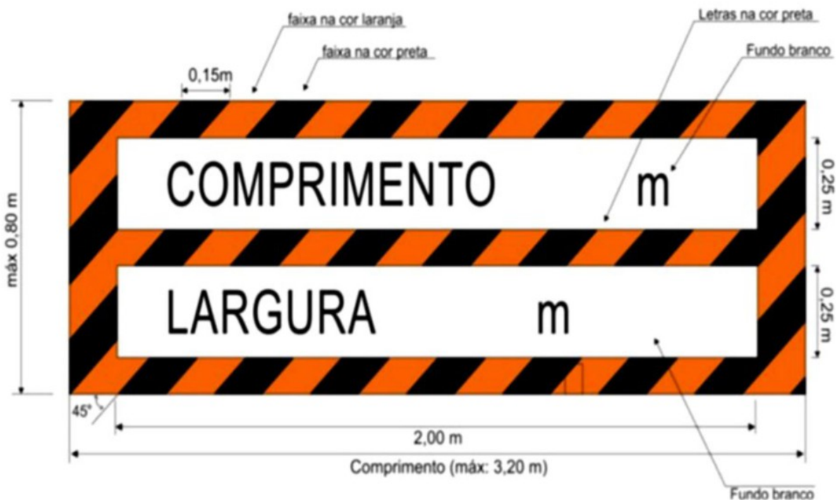
Figura 6: Sinalização especial de advertência traseira para comprimento e largura excedente
